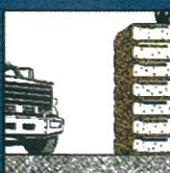
Toprak yapılarda jeotekstil işlevi betonarme yapılarda çeliğin işlevine benzer. Betonarme çökme gerilmelerini çelik karşılaşırken zeminde ise bu görevi jeotekstil malzemeler üstlenir.
