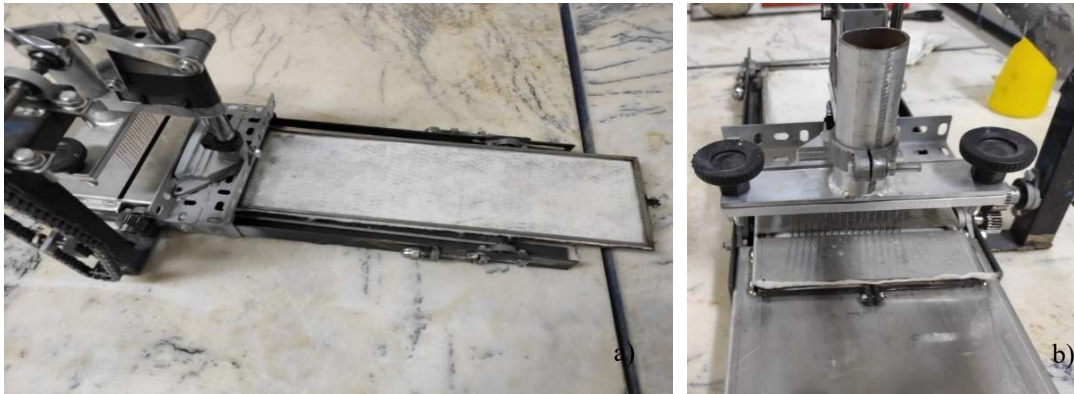
Şekil 3. Laboratuvar koşullarında örnek yapay GKÖ üretimi
