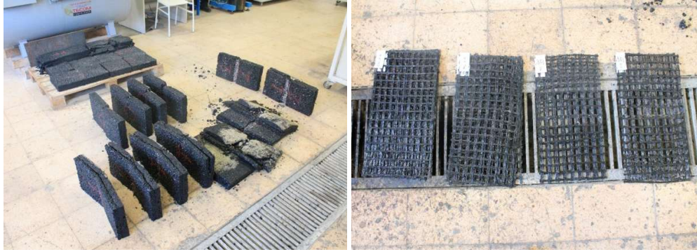
Şekil 11. Çevrimsel yükleme sonucunda tabakalar arasından çıkartılarak çekme testine tabi tutulan geogrid numuneleri
