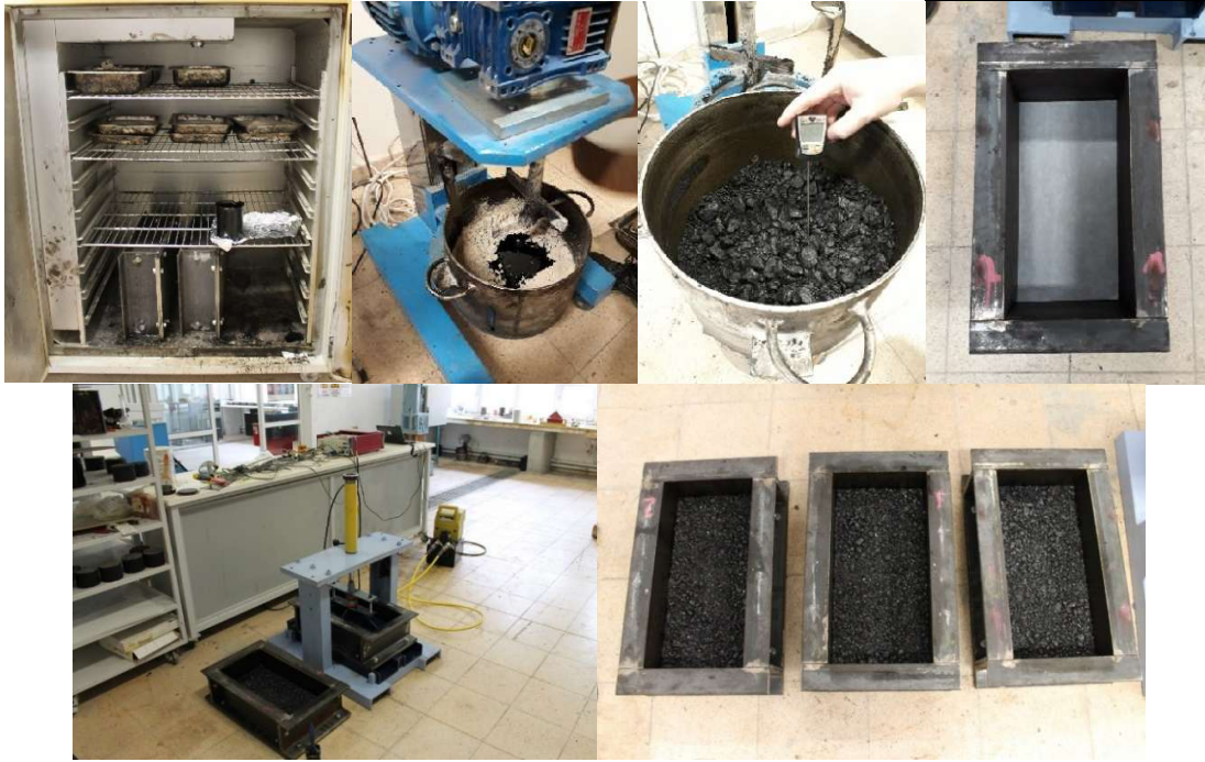
Şekil 5. Plaka numunelerinin hazırlanma süreci (Evirgen vd. 2021)
