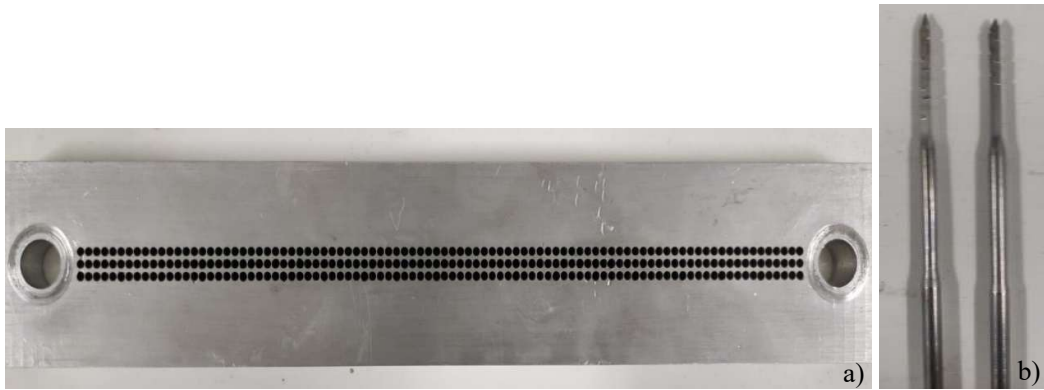
Şekil 2. Laboratuvar tipi iğneleme aletinde kullanılan parçalar a) iğneleme tablası ve b) ters çentikli iğneler
